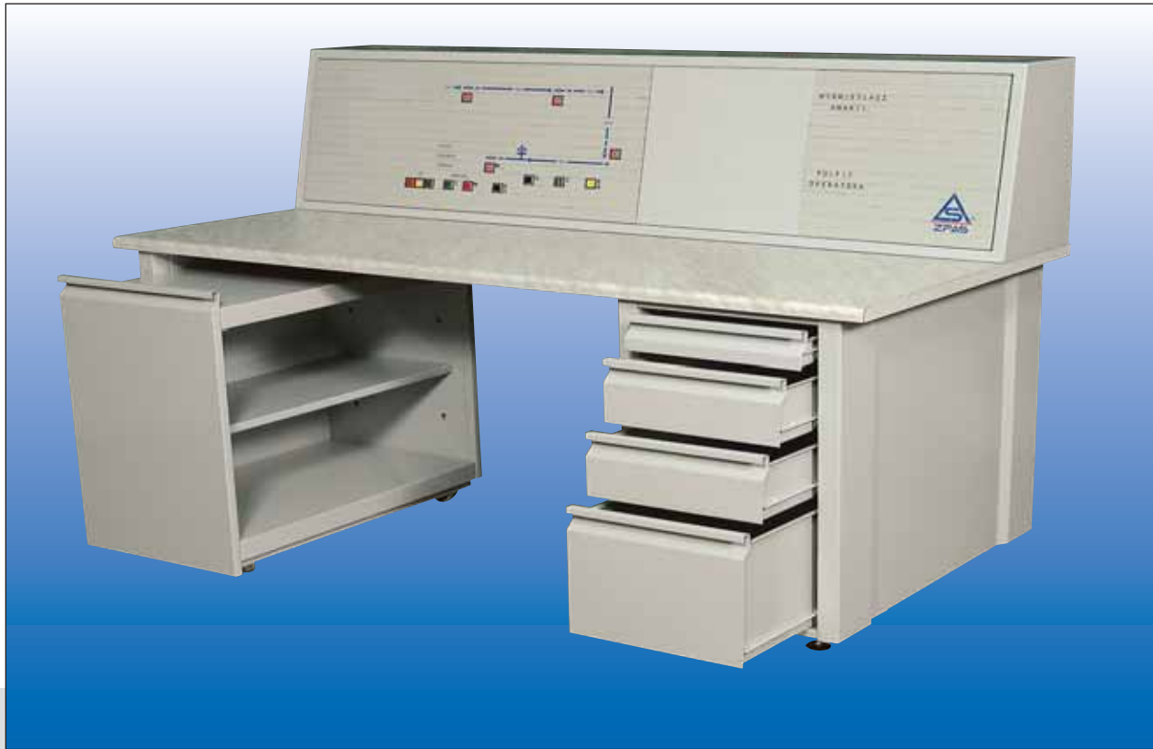
Операторский пульт на одну станцию с надстроечными элементами, структурированными в виде мозаичной синоптической схемы. Для производства корпуса использована листовая сталь. Поверхность корпуса покрыта порошковой краской, столешница изготовлена из ламината
